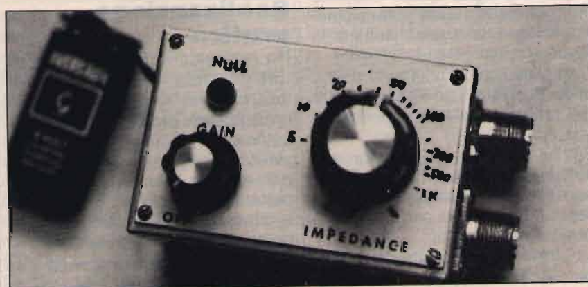
foto 2 "Vista esterna dell'impedenzometro. È stato seguito lo schema di fig. 1, di modo che ne è risultata una scala di lettura non lineare".
