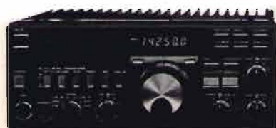
YAESU FT 757 Ricetrasmittitore HF, FM-SSB-CW, copertura continua da 1,6 a 30 MHz, 200 W PeP.
