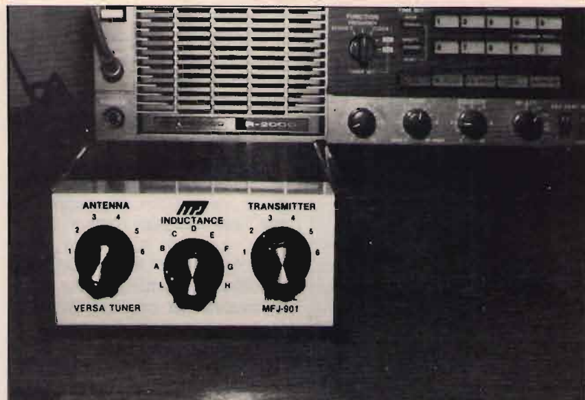
figura 4 Un semplice ed economico accordatore d'antenna.
